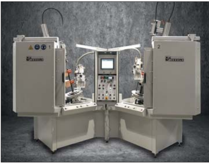
Doppel-Rundnaht-Schweißautomat mit zwei Drehtischen und zentraler Steuerung.
